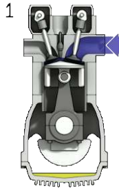
Four-stroke cycle in cylinder ( moteur à quatre temps ) from Wikipedia
